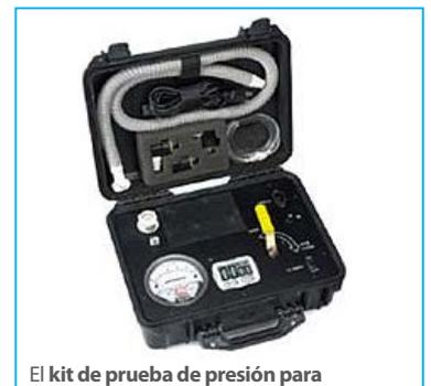
El **kit de prueba de presión para Interceptor® Plus** incluye todos los elementos necesarios para realizar pruebas periódicas, incluyendo: mangueras de conexión y válvulas, ventilador y medidor de presión Magnehelic.
